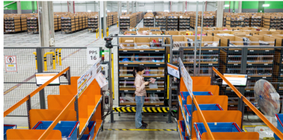
AGV가 수백 개의 상자를 적재자가 있는 곳으로 전달해줍니다. 어느 한여는 물건을 차운 할지 리모콘으로 제어하지 않습니다.
