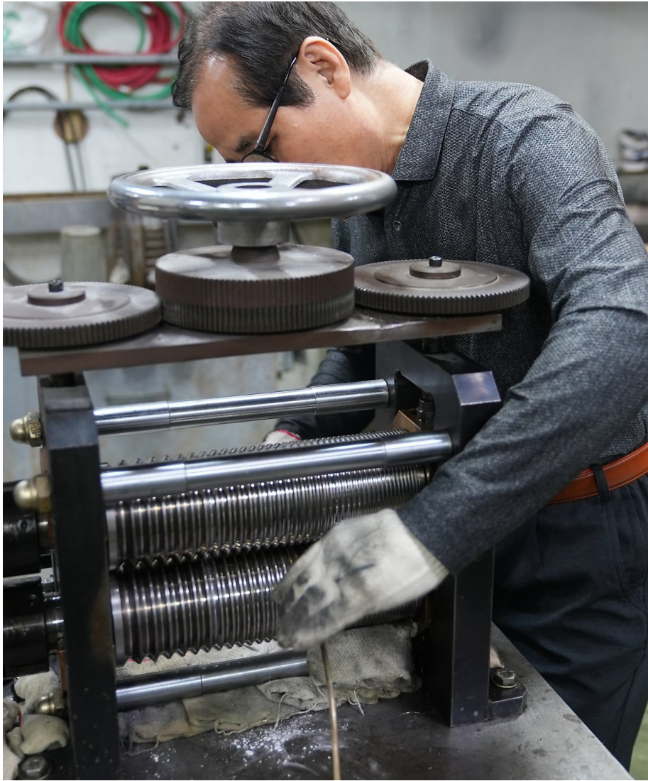
조용일씨 부친인 조원익 대표가 운영하는 귀금속 공장에서 기술자들이 14~18k 금으로 체인목걸이 등을 만드는 과정
