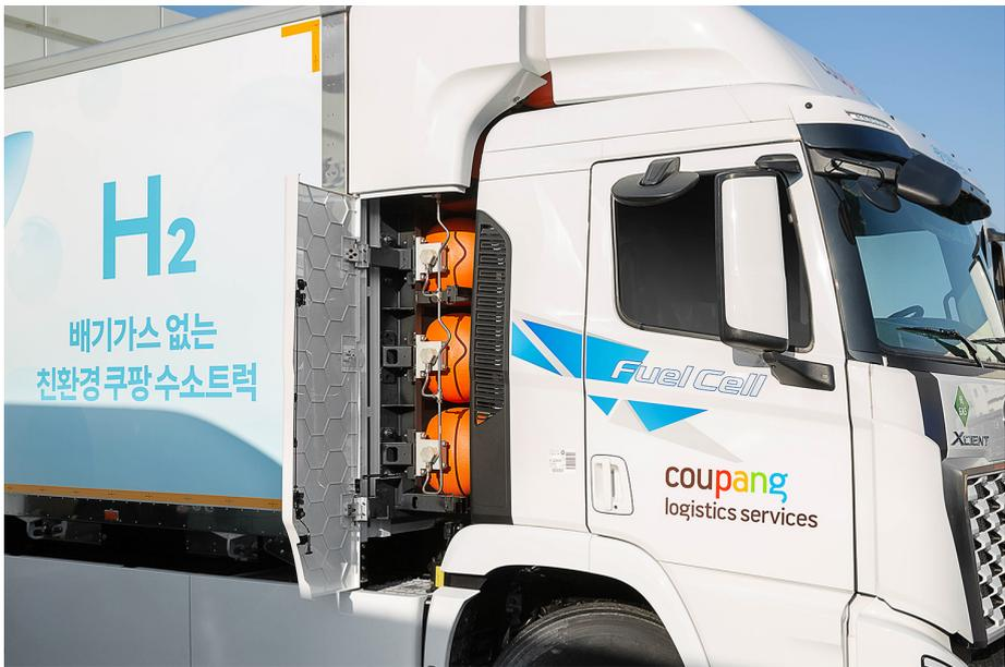
이번에 시범 운행하는 차량은 현대자동차가 만든 11톤급 '엑시언트' 모델입니다. 기존 디젤 트럭과 비슷한 성능을 내면서도 주행 중 이산화탄소나 오염물질을 배출하지 않습니다. 사진의 오렌지색 탱크 안에 연료로 쓰이는 액화수소가 저장됩니다.
