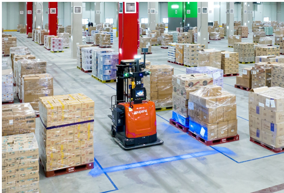
쿠팡 대구 풀필먼트 센터, 직원이 누르는 버튼 한 번으로 알아서 대용량 제품을 옮겨주는 '무인 지게차'
