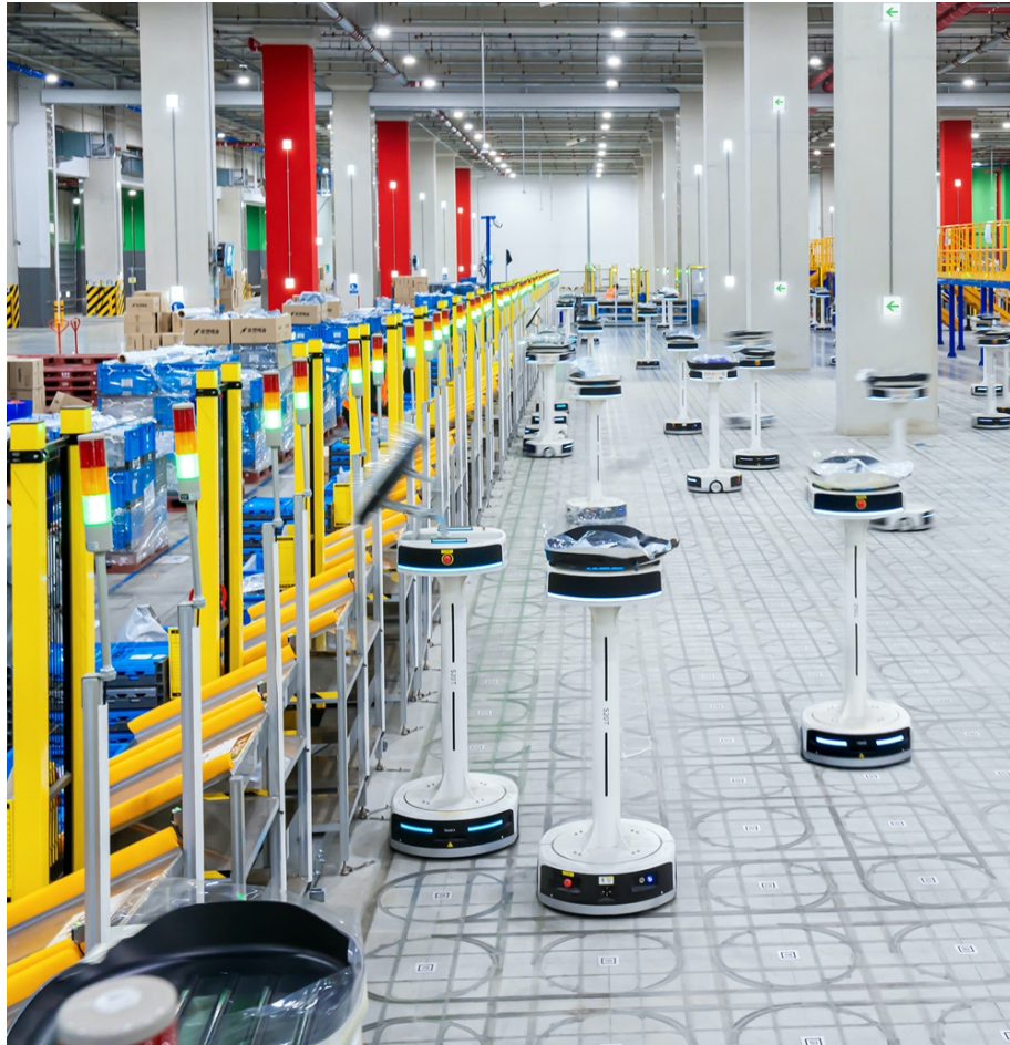
쿠팡 대구 풀필먼트 센터, 상품 포장지에 찍힌 운송장 바코드를 스캐너로 인식 후 배송지별로 상품을 분류하고 옮겨주는 '소팅 봇'
