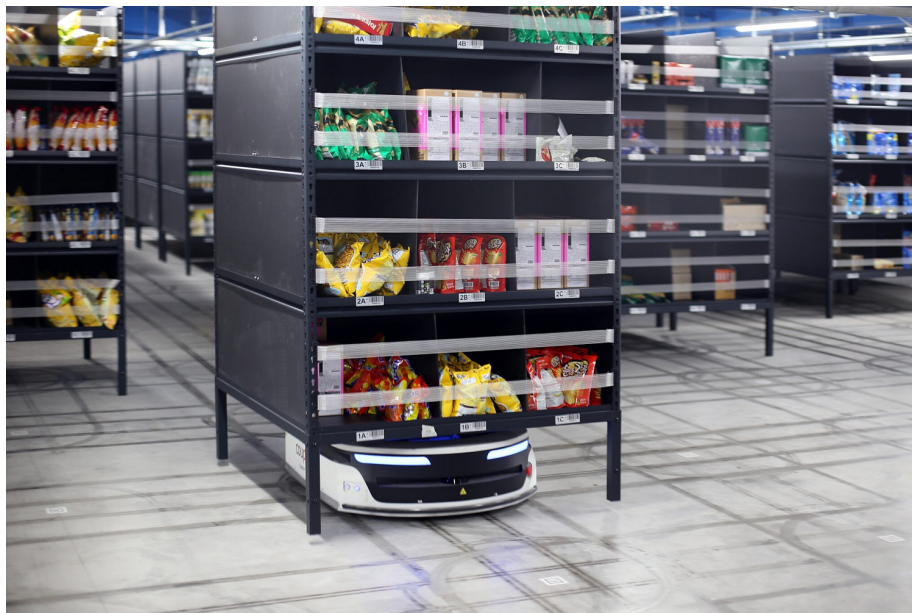
작업자에게 상품을 가져다주는 무인 운반 로봇(AGV)
