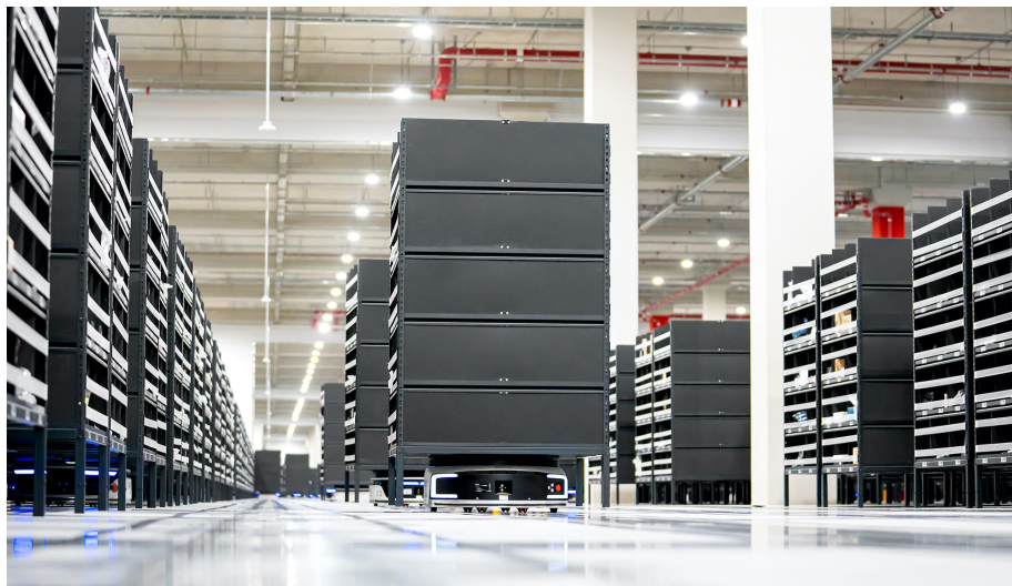
평균 2분 안에 수백 개의 상품을 집품 작업자의 작업대로 운반하는 AGV(Automated Guided Vehicle) 로봇
