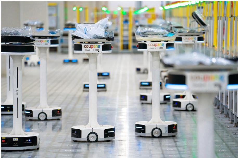
인체공학적인 설계로 분류 작업에 활용되는 소팅 로봇(sorting robots)
