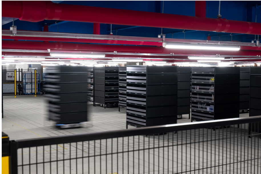
주문이 들어온 상품을 작업자의 작업대로 운반하는 AGV(Automated Guided Vehicle) 로봇. 광주점단물류센터 는AGV가 움직이는 창고 역할을 수행한다
